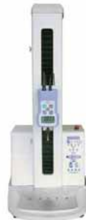
電動歯ブラシの加重測定に 強度試験機 (FGP,FGPXシリーズと電動スタンド)
