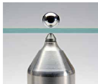
ディスプレイ材料の 厚み計測に 厚み計測器 (ミニテスト7200/7400FH)
